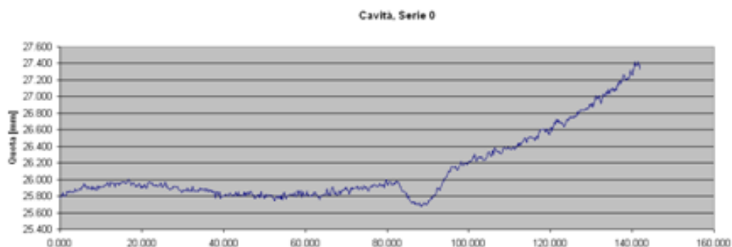
Figura 48: Profondità del difetto (cavità): 0.272mm
